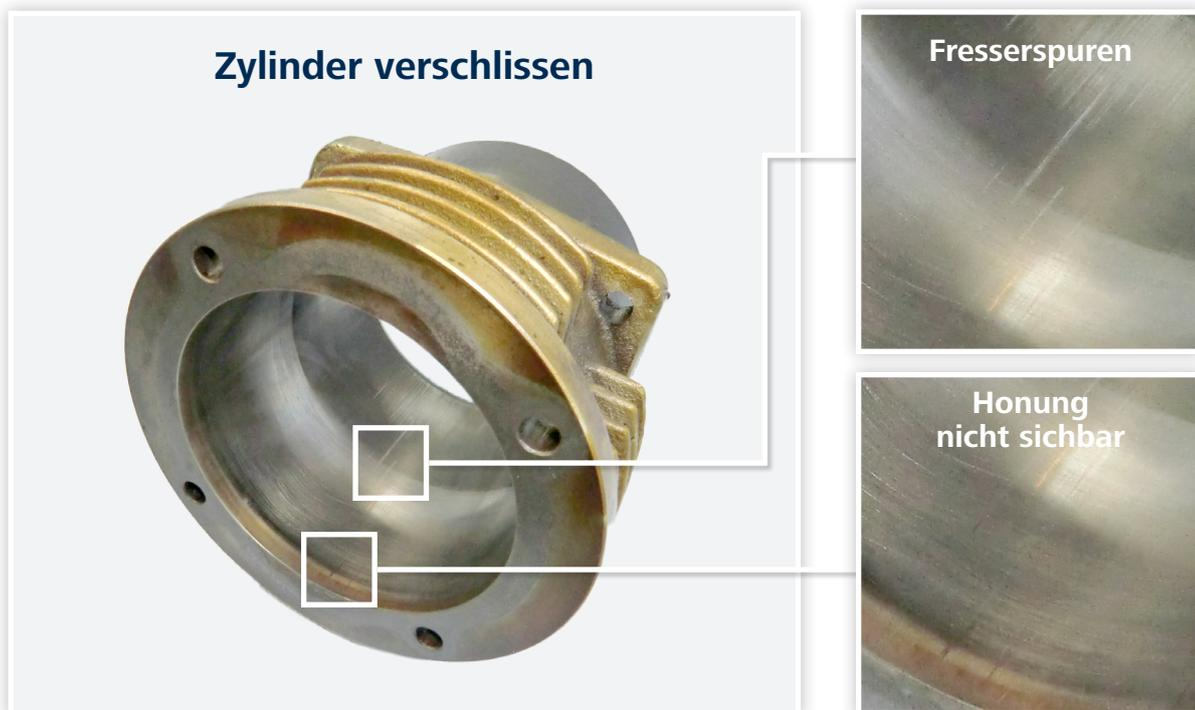
Wenn Sie einen erhöhten Ölverbrauch feststellen oder bei der Wartung die Honung der Zylinder nicht mehr zu sehen ist, ist ein Austausch notwendig. **Bitte beachten Sie, dass bei einem Wechsel immer beide Bestandteile (also Zylinder und Kolbenringe) gleichzeitig zu wechseln sind.**
